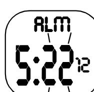
Oprima o mantenga apretado el botón **ADV/ST/SPL.** para recorrer progresivamente los dígitos y despues oprima el botón **MODE**. En seguida destellan los dígitos de los minutos.
